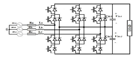
Figure 1. Three-level PWM rectifier.
