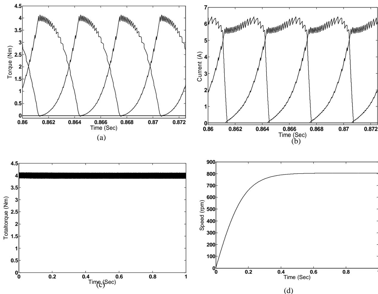
Figure 8. (a) Phase torques (b) Phase currents (c) Total torque (d) Speed
