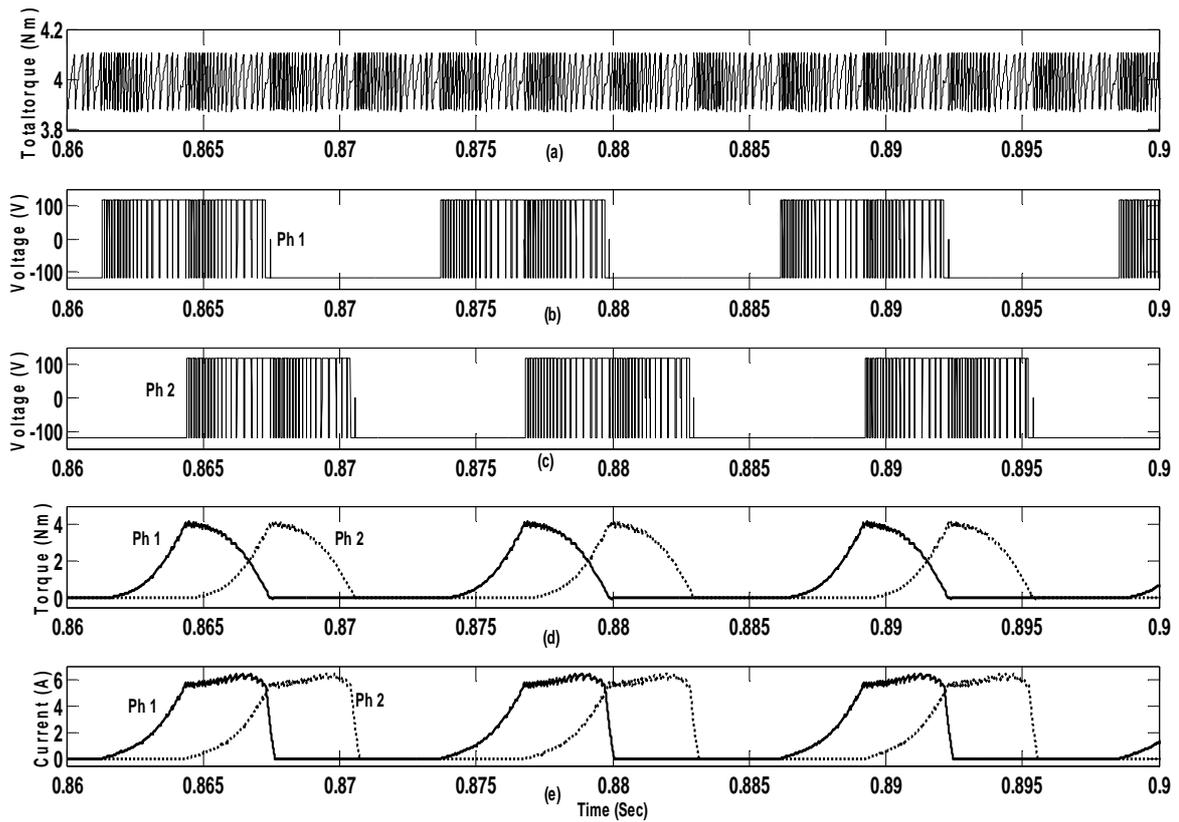
Figure 6. (a) Total torque (b) & (c) Phase voltages (d) Phase torques (e) Phase currents
