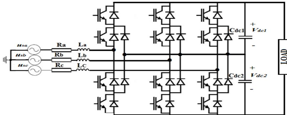
Figure 1. Three-level PWM rectifier.
