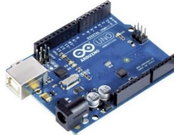
Figure 4. Arduino UNO kit
