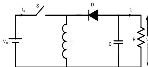
Figure 5(a). Buck-Boost converter
