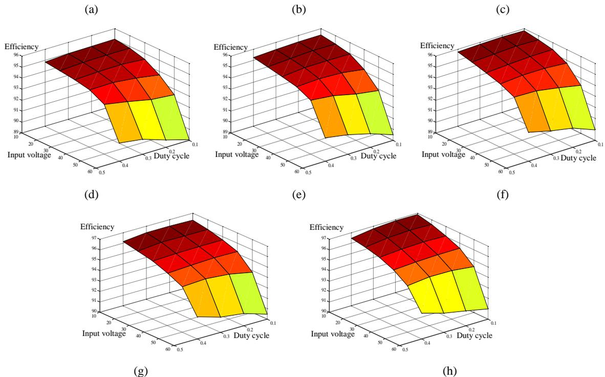
Figure 8. Results of simulations with constant load test (a)  $R=100\ \Omega$ , (b)  $R=90\ \Omega$ , (c)  $R=80\ \Omega$ , (d)  $R=70\ \Omega$ , (e)  $R=60\ \Omega$ , (f)  $R=50\ \Omega$ , (g)  $R=40\ \Omega$ , and (h)  $R=30\ \Omega$
